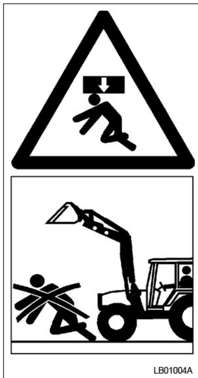
Ilustr. 2: Zagrożenie dla osób w strefie pracy ładowacza czołowego
