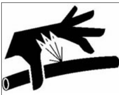
Ilustr. 4: Niebezpieczeństwo obrażeń przez wyciekający olej
