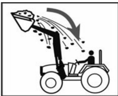
Ilustr. 1: Zagrożenie dla kierowcy wskutek zwiększania kąta narzędzia
